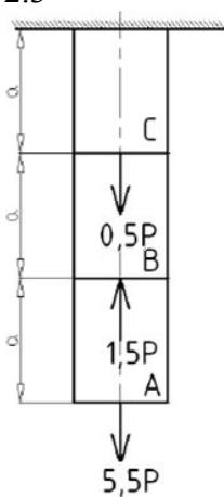
Задача 3. Для заданной схемы определить критическую силу, при превышении которой элемент конструкции потеряет устойчивость.
